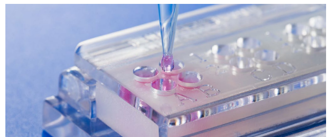
Im ClickIt-Well werden die Zellen direkt auf dem Material auf einer definierten Fläche kultiviert (IKTS-Patent DE102018221415).
